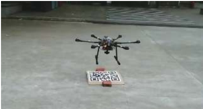
(c) 无人机在模糊自适应速度 PID 控制系统的降落过程
