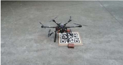
(b) 无人机在速度 PID 控制系统的降落结果
