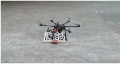
(d) 无人机在模糊自适应速度 PID 控制系统的降落结果
